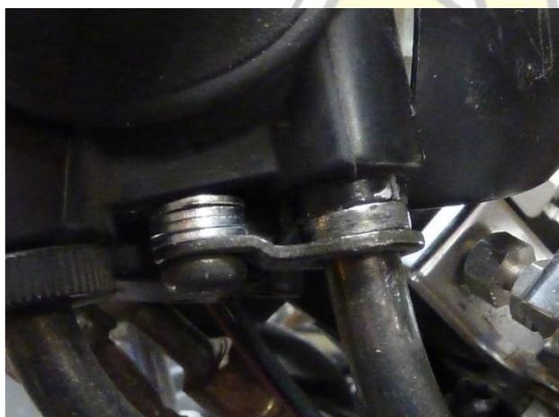
Le quattro rondelle servono per compensare la differente posizione della battuta di fermo della guaina ora che c'è la boccola in posizione. Per fortuna la guaina posteriore, quella del cavo che "chiude" le farfalle, non necessita di modifiche.
