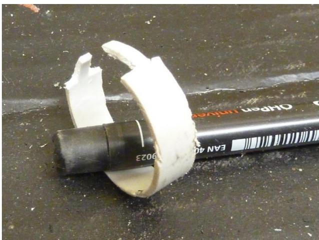
L'importante è dimensionare correttamente le punte di ogni anello dalla parte che si inserisce sul davanti, cioè dalla parte del cavo che "apre", questo perché il cavo non deve fare una piega secca appena parte dal nottolino, ma va accompagnato dal diametro originale ad diametro maggiorato facendolo appoggiare su una rampa.
